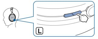
При подсоединении наушников с помощью аудиокабеля функция Bluetooth автоматически выключается, а вызовы не могут быть выполнены с помощью наушников.
