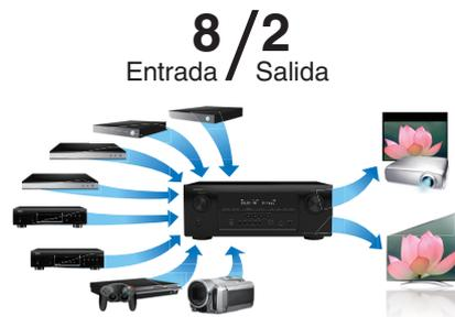
Esta unidad está equipada con 8 entradas HDMI y 2 salidas HDMI que permiten la conexión a varios dispositivos compatibles HDMI, como por ejemplo reproductores Blu-ray Disc, consolas de videojuegos y videocámaras de HD. Esta unidad está equipada con 2 salidas para monitor, permitiéndole proyectar la misma imagen al mismo tiempo utilizando esta unidad.
