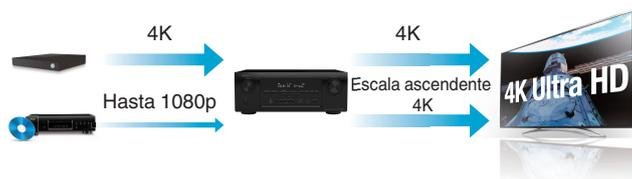
Esta unidad está equipada con una función de escalado de vídeo de 4K que permite la salida de vídeo analógico o SD (definición estándar) a través de HDMI a una resolución de 4K (3840 × 2160 píxeles). Esta función habilita la conexión del dispositivo a una TV utilizando un solo cable HDMI y produce imágenes en alta definición para cualquier fuente de vídeo.
