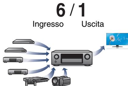
Questa unità è dotata di 6 ingressi HDMI e 1 uscita HDMI che consentono il collegamento a vari dispositivi compatibili con HDMI, quali lettori Blu-ray Disc, console per giochi e videocamere HD.
