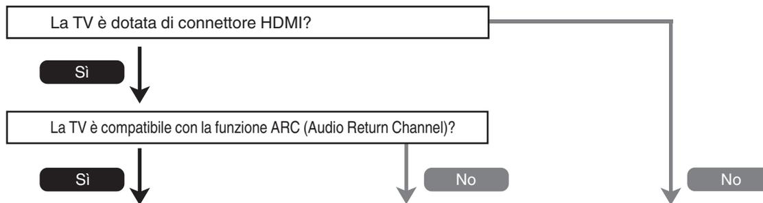
**“Collegamento 1: TV dotata di connettore HDMI e compatibile con la funzione ARC (Audio Return Channel)”** (☞ p. 48)
