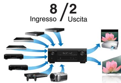
Questa unità è dotata di 8 ingressi HDMI e 2 uscite HDMI che consentono il collegamento a vari dispositivi compatibili con HDMI, quali lettori Blu-ray Disc, console di gioco e videocamere HD. Questa unità è dotata di 2 uscite monitor, che consentono di proiettare la stessa immagine allo stesso tempo usando questa unità.
