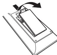
2 乾電池(2本)を乾電池収納部の表示に合わせて正しく入れる。
