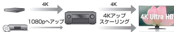
本機には、SD(Standard Definition)映像を4K(3840×2160ピクセル)の解像度にしてHDMIへの出力を可能にする4Kビデオアップスケーリング機能を搭載しています。これにより本機とテレビの接続がHDMIケーブル1本で済むだけでなく、どの映像ソースでも高精細な映像を再現することができます。
