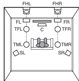
■ サラウンドバックスピーカーを使用して7.1チャネルのスピーカーを設置するとき
