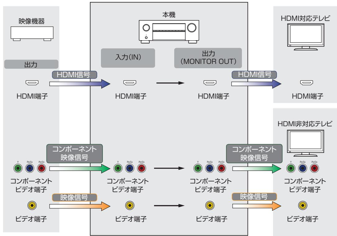
本機では、入力された映像信号を、メニューの“解像度”で設定した解像度に変換してテレビに出力できます。(☞[170 ページ](#))
