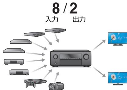
本機には 8 系統の HDMI 入力端子と 2 系統の HDMI 出力端子を装備しており、ブルーレイディスクプレーヤー、ゲーム、HD ビデオカメラなどのさまざまな HDMI 端子付き機器との接続ができます。また、本機は 2 つのモニター出力を装備しており、同時に同じ映像を映し出すことができます。
