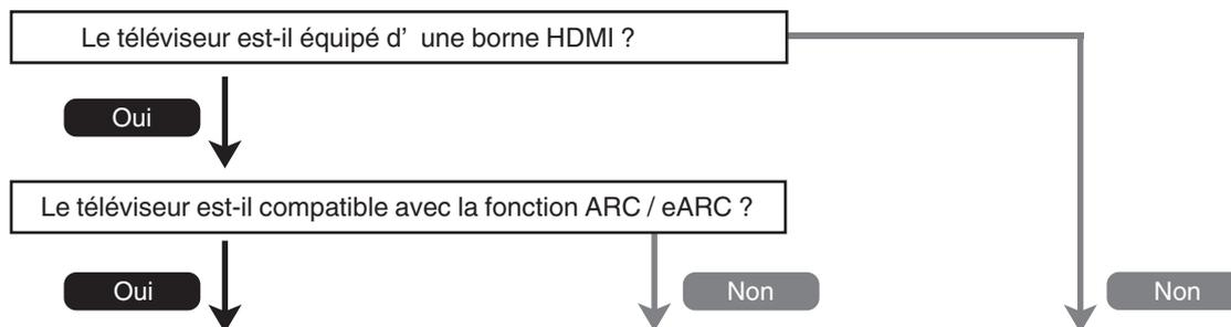
“Connexion 1 : Téléviseur équipé d'une borne HDMI et compatible avec la fonction ARC (Audio Return Channel) / eARC (Enhanced Audio Return Channel)” (☞ p. 65)
