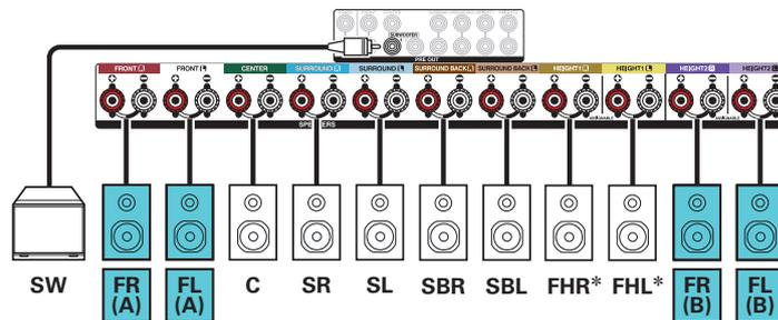
\* Les enceintes hautes, les enceintes au plafond et les enceintes Dolby Atmos Enabled peuvent être connectées sur les bornes d'enceinte HEIGHT1. Réglez les enceintes à connecter depuis "Hauteur" - "Agencement" dans le menu. (☞ p. 215)
