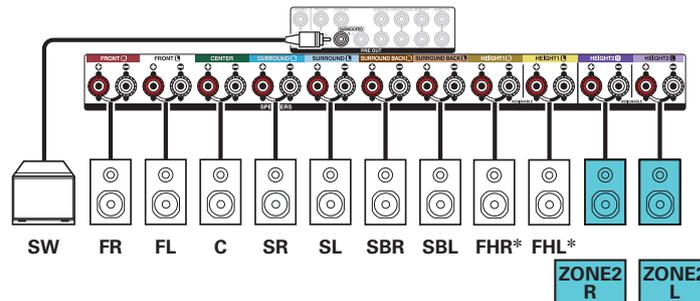
\* Les enceintes hautes, les enceintes au plafond et les enceintes Dolby Atmos Enabled peuvent être connectées sur les bornes d'enceinte HEIGHT1. Réglez les enceintes à connecter depuis "Hauteur" - "Agencement" dans le menu. (☞ p. 215)
