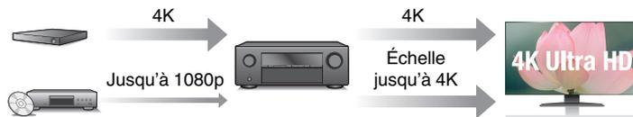
Cet appareil est équipé d'une fonction de vidéo ascendante 4K qui permet à la vidéo analogique ou vidéo SD (Standard Definition) d'être émise en résolution HDMI à 4K (3840 × 2160 pixels). Cette fonction permet à l'appareil d'être connecté à un téléviseur à l'aide d'un simple câble HDMI, et de produire des images en haute définition pour n'importe quelle source vidéo.
