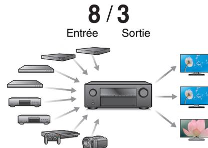
Pour la connexion à un large éventail de sources numériques, cet appareil offre 8 entrées HDMI, y compris 1 sur le panneau avant vous permettant de rapidement et facilement connecter un caméscope, une console de jeux vidéo ou tout autre appareil équipé HDMI. Il y a deux sorties HDMI pour la pièce principale et une troisième sortie HDMI pour ZONE2.
