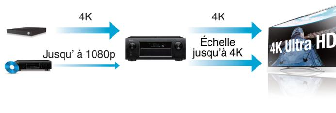
Cet appareil est équipé d'une fonction de vidéo ascendante 4 K qui permet à la vidéo analogique ou vidéo SD (Standard Definition) d'être émise en résolution HDMI à 4K (3840 × 2160 pixels). Cette fonction permet à l'appareil d'être connecté à une TV à l'aide d'un simple câble HDMI, et de produire des images en haute définition pour n'importe quelle source vidéo.
