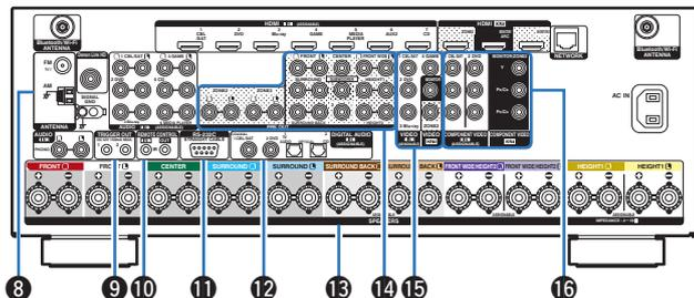
**8 Bornes d'antenne FM/AM (ANTENNA)**
