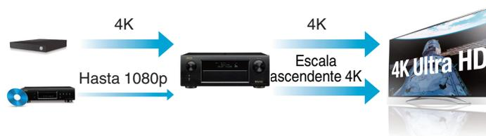
Esta unidad está equipada con una función de escalado de vídeo de 4K que permite la salida de vídeo analógico o SD (definición estándar) a través de HDMI a una resolución de 4K (3840 x 2160 píxeles). Esta función habilita la conexión del dispositivo a una TV utilizando un solo cable HDMI y produce imágenes en alta definición para cualquier fuente de vídeo.
