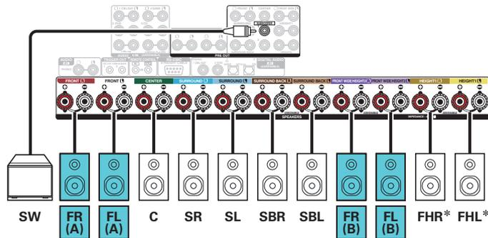
\* Les enceintes hautes, les enceintes au plafond et les enceintes Dolby Atmos Enabled peuvent être connectées sur les bornes d'enceinte HEIGHT 1. Réglez les enceintes à connecter depuis "Hauteur" - "Agencement" dans le menu. (☞ p. 247)
