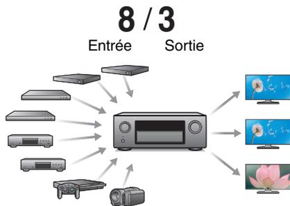
Pour la connexion à un large éventail de sources numériques, cet appareil offre 8 entrées HDMI, y compris 1 sur le panneau avant vous permettant de rapidement et facilement connecter un caméscope, une console de jeux vidéo ou tout autre appareil équipé HDMI. Il y a deux sorties HDMI pour la pièce principale et une troisième sortie HDMI pour une autre pièce.
