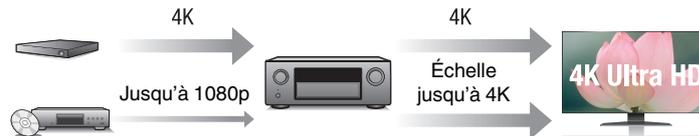
Cet appareil est équipé d'une fonction de vidéo ascendante 4 K qui permet à la vidéo analogique ou vidéo SD (Standard Definition) d'être émise en résolution HDMI à 4K (3840 × 2160 pixels). Cette fonction permet à l'appareil d'être connecté à une TV à l'aide d'un simple câble HDMI, et de produire des images en haute définition pour n'importe quelle source vidéo.
