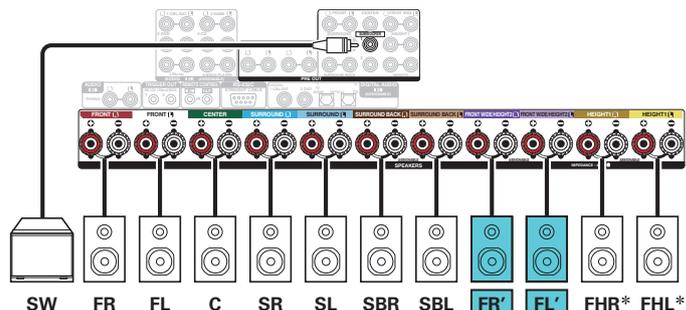
\* Les enceintes hautes, les enceintes au plafond et les enceintes Dolby Atmos Enabled peuvent être connectées sur les bornes d'enceinte HEIGHT1. Réglez les enceintes à connecter depuis "Hauteur" - "Agencement" dans le menu. (☞ p. 247)
