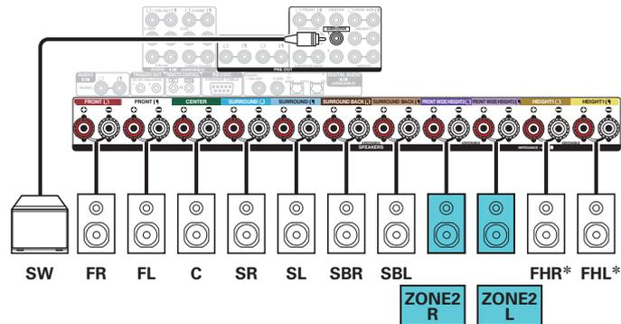
\* Les enceintes hautes, les enceintes au plafond et les enceintes Dolby Atmos Enabled peuvent être connectées sur les bornes d'enceinte HEIGHT1. Réglez les enceintes à connecter depuis "Hauteur" - "Agencement" dans le menu. (☞ p. 247)
