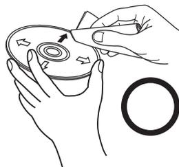
Essuyez délicatement le disque par des mouvements rectilignes allant du centre au bord.
