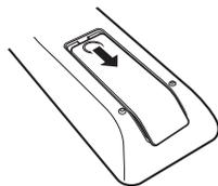
2 乾電池(1本)を乾電池収納部の表示に合わせて正しく入れる。
