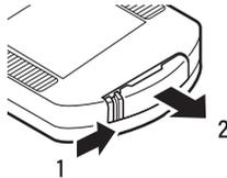
3. Setzen Sie die Lithiumbatterie (CR2025) wie angegeben richtig in das Batteriefach ein.
