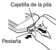
2. Introduzca correctamente la pila de litio en el compartimiento de pilas como se indica.
