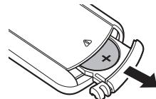
3. 古い電池を取り外し、新しいコイン型リチウム電池(CR2025)を+の刻印を上に向け、電池ケースに入れる。
